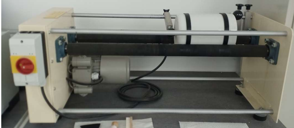
Abbildung 5: Kugelmühle zum Mahlen der Oxidationsmittel
