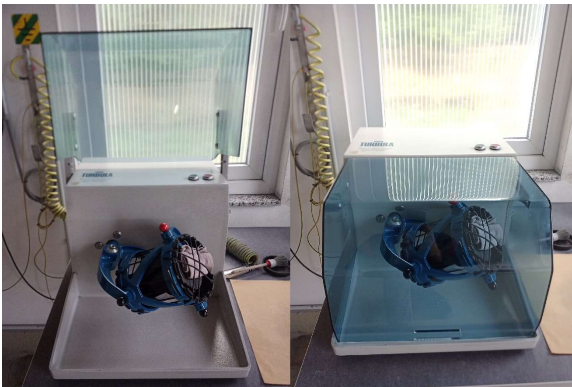
Abbildung 6: 3D Pulvermischer Turbula (links: offene Einhausung, rechts: geschlossene Einhausung)
