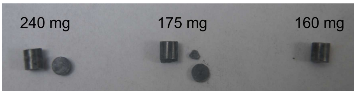
Abbildung 66: \text{SrO}_2/\text{Zr} Pellets mit 5 % MgSt als Bindemittel und verschiedenen Pelletgewichten nach erfolgtem Falltest
