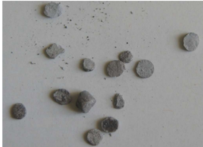
Abbildung 48: Nicht reagierte Pelletbruchstücke des \text{SrO}_2/\text{Al}/\text{MgSt} 1 Versuches
