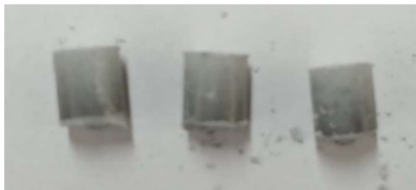
Abbildung 89: \text{Li}_2\text{O}_2/\text{Si} Pellets mit farblichem Verlauf hergestellt an der Pneumatik Presse
