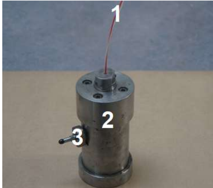
Abbildung 24: Druckbombe mit einem piezoelektrischen Druckaufnehmer und einem bereits eingesetzten Brückenanzünder
