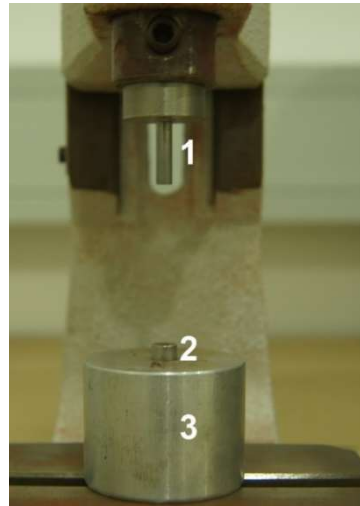
Abbildung 9: Kniehebelpresse zum Auswerfen der Pellets aus der Hülse
