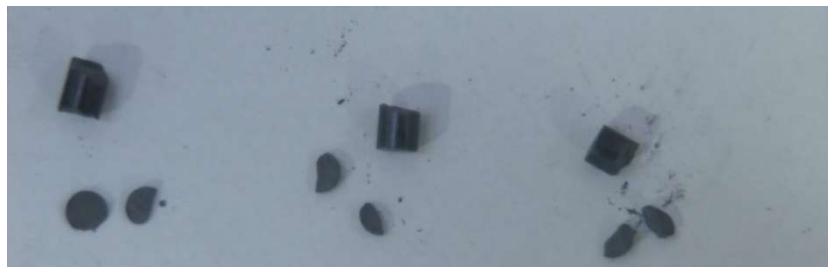
Abbildung 64: \text{SrO}_2/\text{Zr} Pellets mit 2,5 % MgSt als Bindemittel nach erfolgtem Falltest
