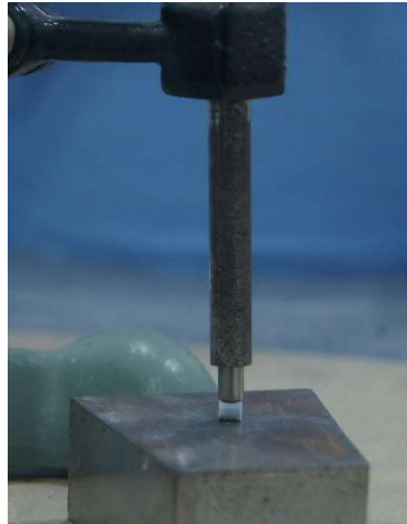
Abbildung 17: Radial eingespanntes Pellet vor der Belastung mit Gewichten
