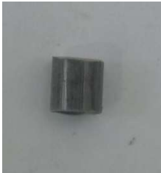
Abbildung 90: \text{Li}_2\text{O}_2/\text{Si} Pellets hergestellt an der Tablettenpresse TDP 0
