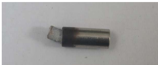
Abbildung 91: \text{CaO}_2/\text{Al}/\text{MgSt} Reaktionsprodukte die sich aus der Hülse herausbewegen Eine mögliche Ursache für dieses Phänomen könnte in der geringen Reinheit
