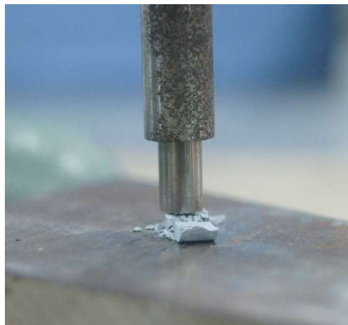
Abbildung 18: Pellet nach Bruch durch radiale Gewichtsbelastung
