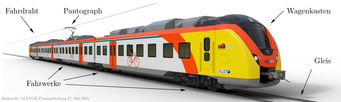
Abbildung 2.6: Typischer Aufbau eines Schienenfahrzeuges bestehend aus Wagenkästen und Fahrwerken am Beispiel des 4-teiligen ALSTOM Coradia Continental Regionalzuges.
