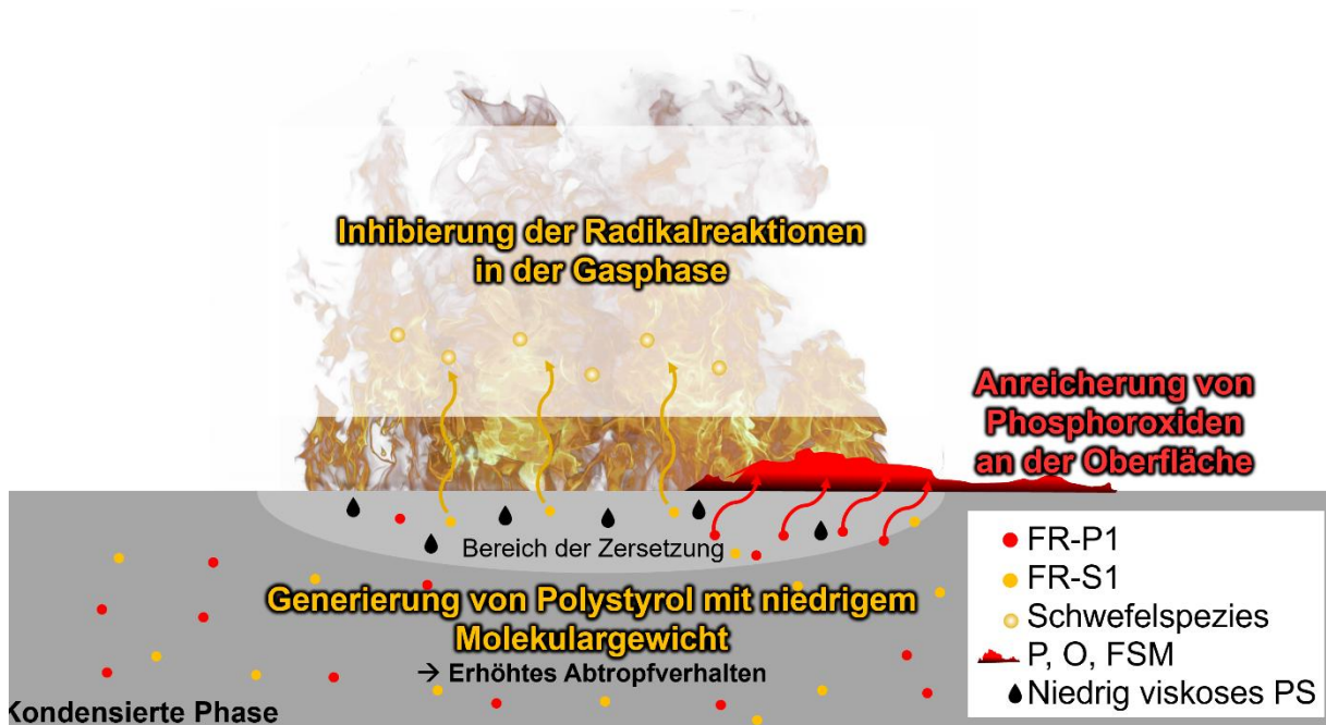
Abbildung 64: Schematische Darstellung des vorgeschlagenen flammenhemmenden Mechanismus des P-S-Flammschutzsystems in Polystyrolschaumstoffen.
