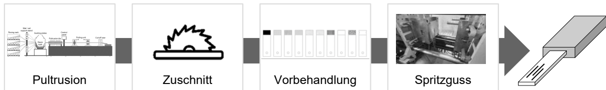
Abbildung 4.2: Prozesskette zur Herstellung des Hybridverbunds
