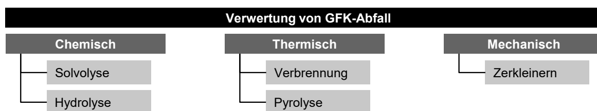
Abbildung 8.2: Möglichkeiten zur Verwertung von GFK-Abfall
