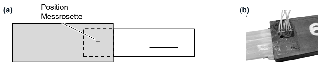
Abbildung 6.3: (a) Probengeometrie mit Position der Bohrungen und (b) Aufnahme der Probe mit applizierter Messrosette
