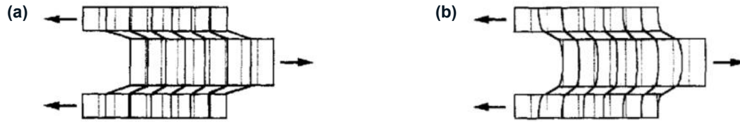
Abbildung 2.11: Gegenüberstellung der Schubverformung zwischen (a) Volkersen mit Schubverformung ausschließlich in der Grenzschicht und (b) TSAI et al. mit Schubverformung im gesamten Verbund [66]
